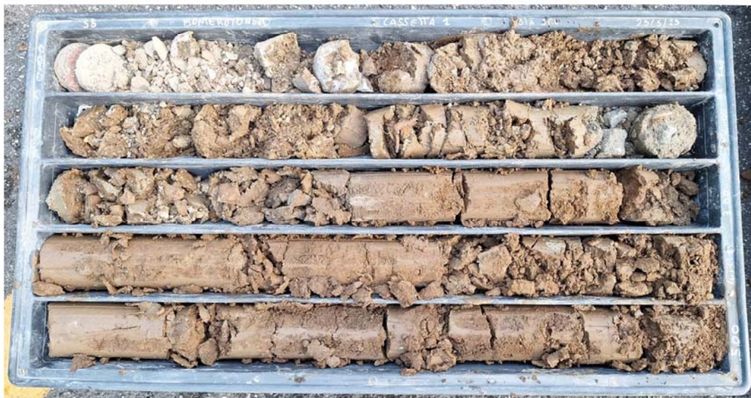
I primi 5 metri della carota del S5. Si osservano frammenti laterizi e di calce intorno ai 2 m di profondità
